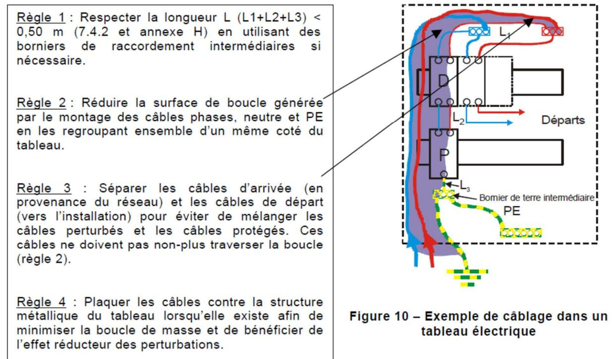
Figure 10 – Exemple de câblage dans un tableau électrique
